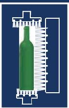
Il lavaggio della bottiglia è realizzato con l'utilizzo di spazzole rotanti bagnate da un getto d'acqua nebulizzata (5). (Generalmente si impiega acqua fredda, possibilmente con una durezza limitata).
